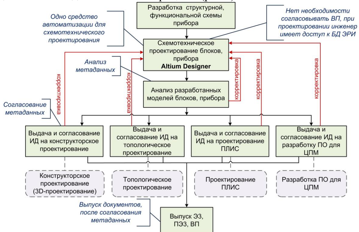
Рис. 5. Модель «как должно быть» бизнес-процесса «Схемотехническое проектирование»
