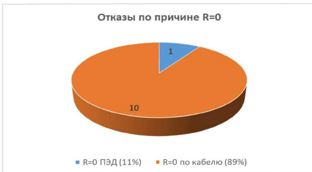
Рисунок 3.5 - Характеристика отказов погружного кабеля по причине R=0
