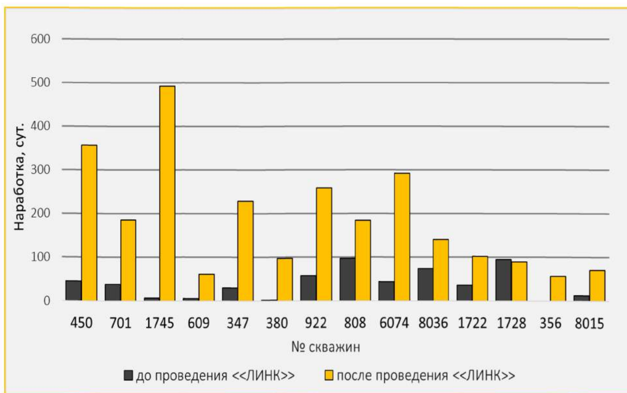
Рисунок 4.3 - Нарботка на отказ по скважинам Покурской свиты до и после применения технологии «ЛИНК»
