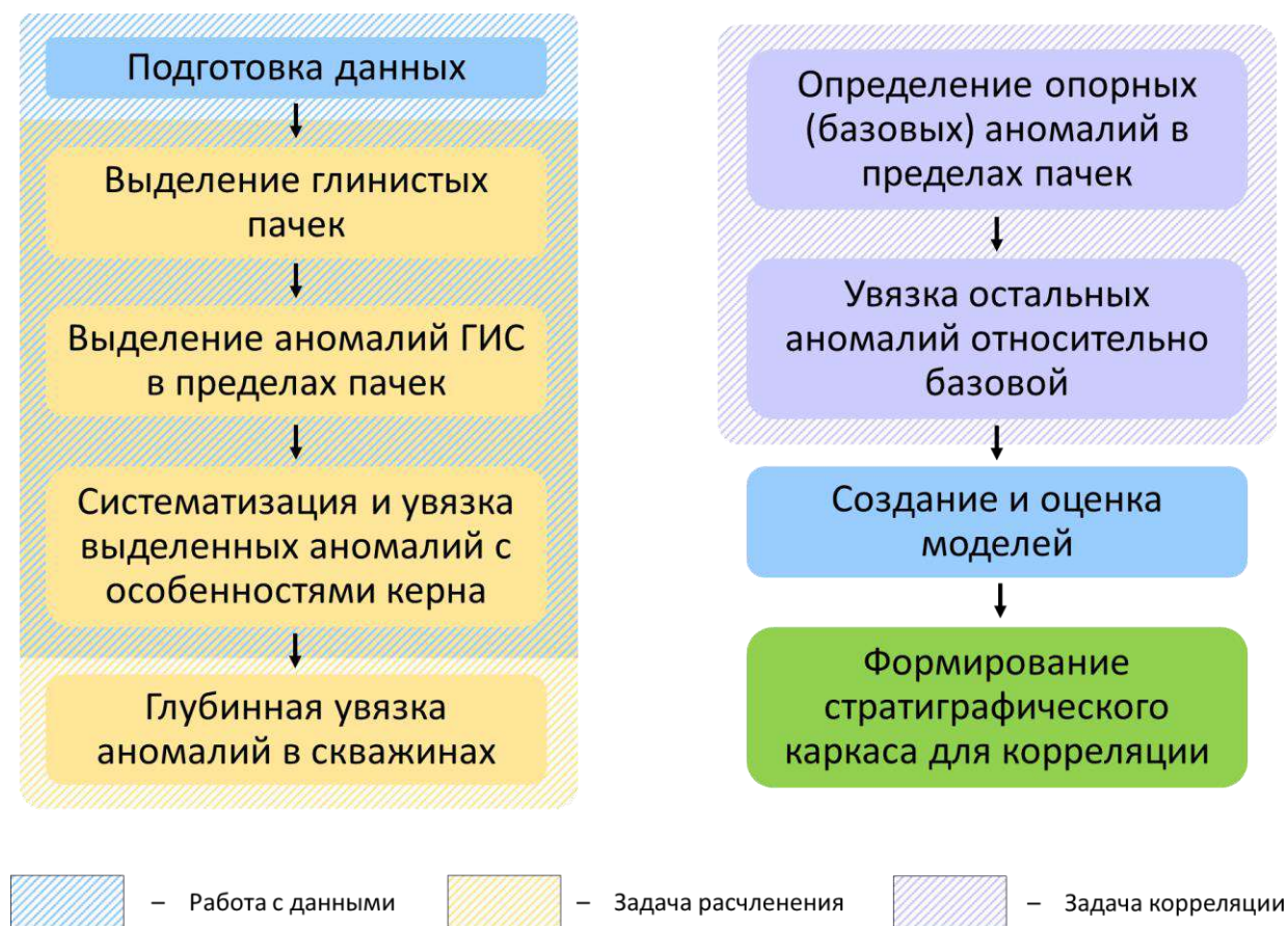
Рисунок 3.4 – Итоговая схема автоматизированного алгоритма расчленения и корреляции геологических горизонтов
