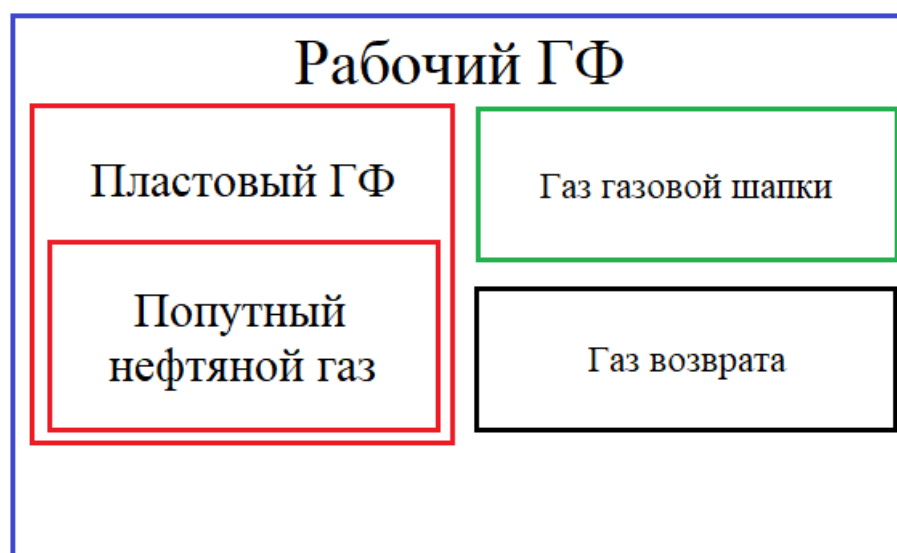
Рисунок 5 – Различие между пластовым и рабочим газовым фактором
