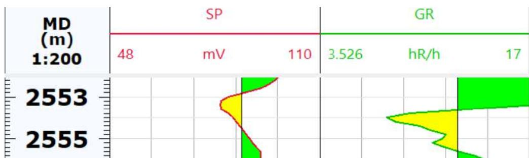
Рисунок 3.11 – Чашеобразная форма кривых ПС и ГК, соответствующая фации переходной зоны пляжа
