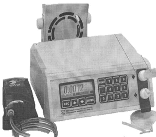
Рисунок 3.2 – Вибрационный измеритель плотности жидкостей ВИП-2М
