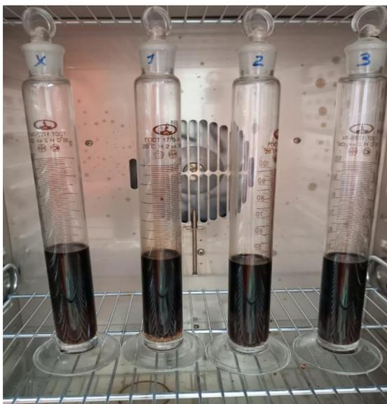
Рисунок 3.4 – Результат разделения эмульсии исходной нефти и нефти с добавлением Сепарол WF-41
