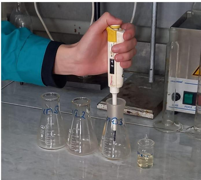
Рисунок 3.3 – Процесс дозирования деэмульгатора в конические колбы.
