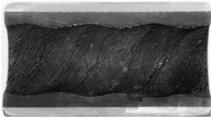
Рисунок 2.4 – Характер повреждения эластомера статора при превышении рабочей температуры [4]
