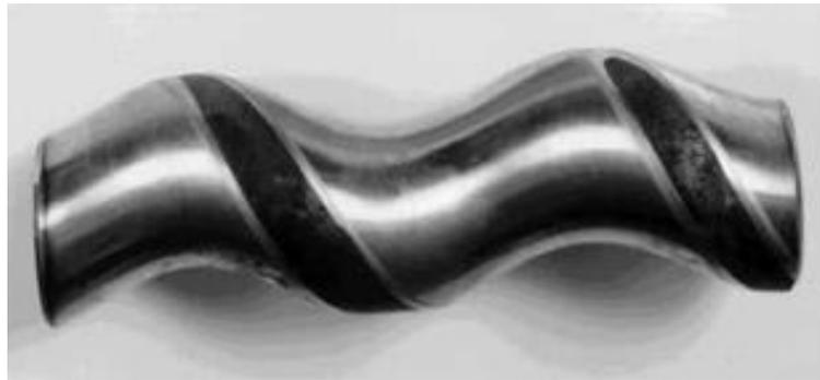
Рисунок 2.7 – Износ поверхности ротора одновинтового насоса до основного металла [4]
