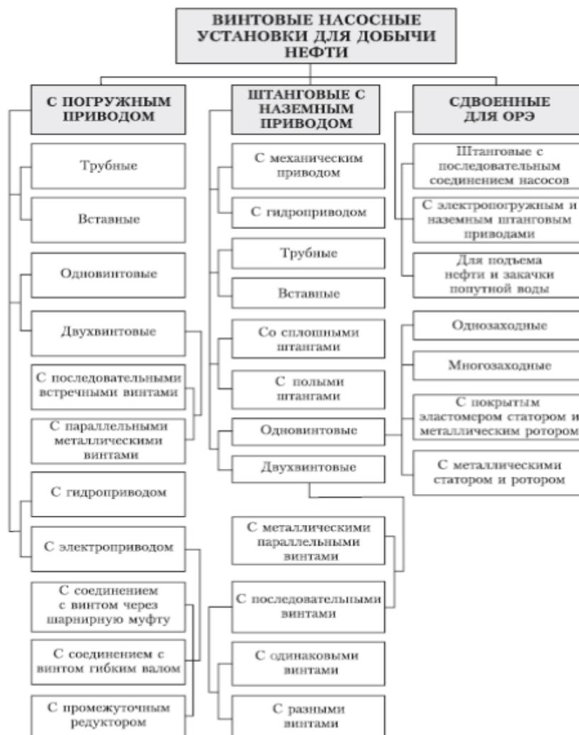
**Рисунок 1.1. Классификация винтовых насосных установок для добычи нефти: ОРЭ – одновременно-раздельная эксплуатация [2]**
