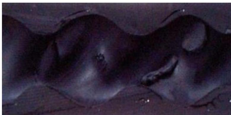
Рисунок 2.3 – Характер повреждения эластомера статора в результате взрывной декомпрессии [3]
