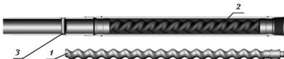
**Рисунок 1.2. Одновинтовой насос:**
