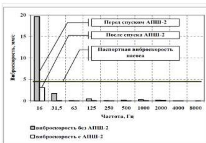
Рисунок 3 — Сравнительная оценка виброскорости насосной установки ГС-3000 в скважине № 668 до и после спуска АПШ
