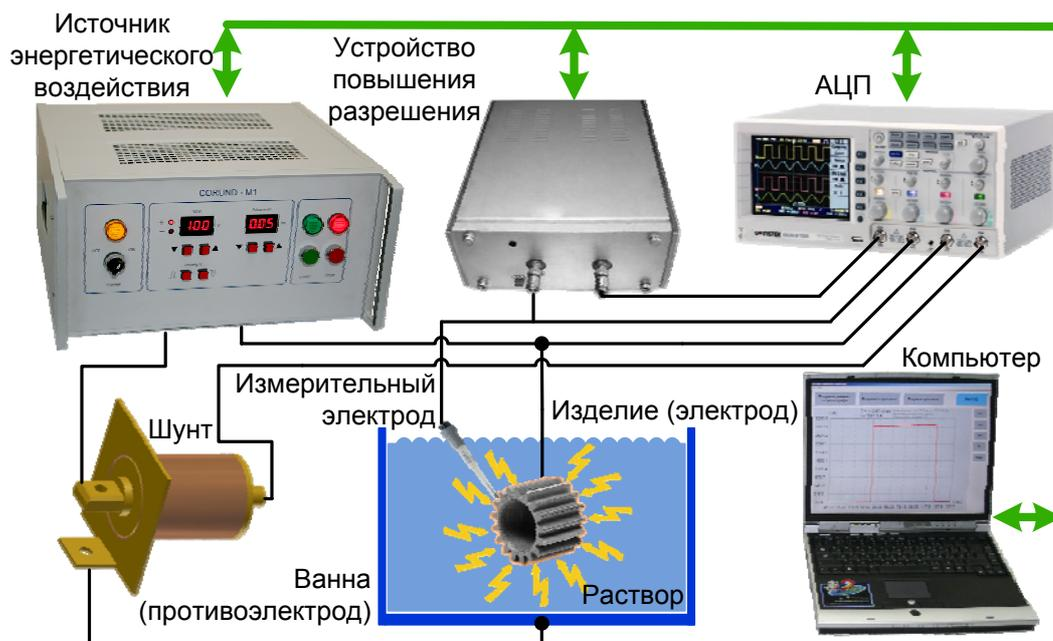
Рис. 1 Микроплазменная система
