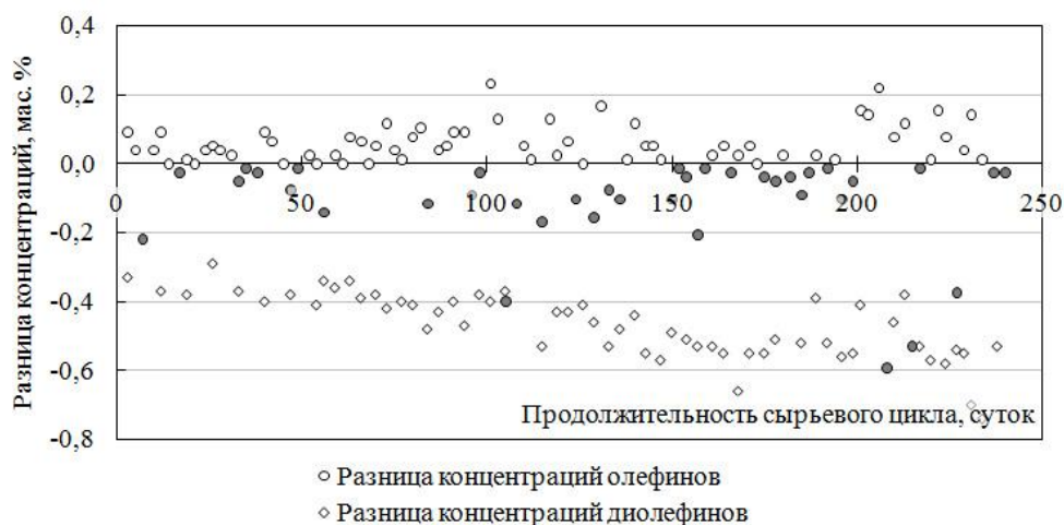
Рис. 3. Эффективность реактора гидрирования при постоянной подаче серосодержащего соединения
