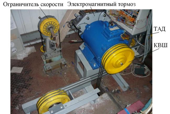
Рис. 10. Общий вид безредукторного электропривода действующей лифтовой лебедки
