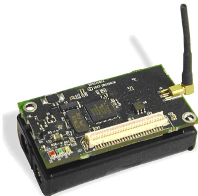
Рисунок 16. Беспроводной модуль MICAz
