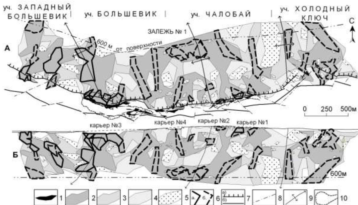
Рис. 8. Проекция богатых, рядовых, бедных и убогих золотосодержащих руд залежи № 1 на горизонтальную (А) и вертикальную (Б) плоскости:
