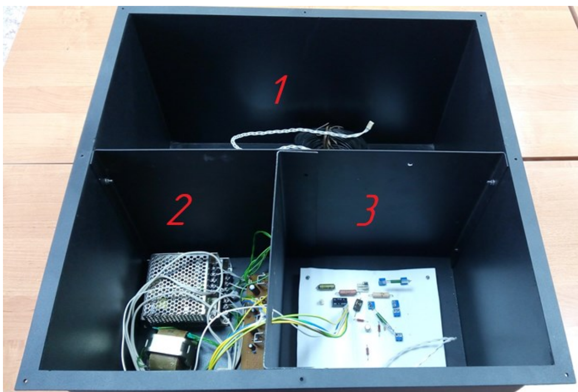
1 – контролируемый кабель; 2 – источник питания; 3 – ПСН
