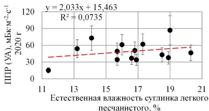
Рисунок 4.6 – Зависимость значений ППР от естественной влажности суглинка легкого песчанистого (площадка 7)
