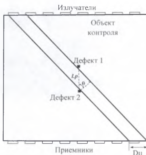
Рис. 7. Акустический тракт для исследования разрешающей способности, \theta - угол между линией соединяющей два дефекта и нормалью к линии, соединяющей излучатель с приемником, D - размер дефекта
