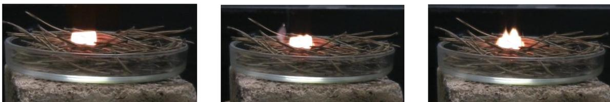
Рис. 2. Характерные кадры видеोगраммы процесса зажигания ЛГМ (хвоя сосны): а)  $t=0,08$  с – инертный прогрев слоя ЛГМ; б)  $t=0,20$  с – появление пламени (зажигание ЛГМ); в)  $t=0,32$  с – объединение пламени над частицей;
