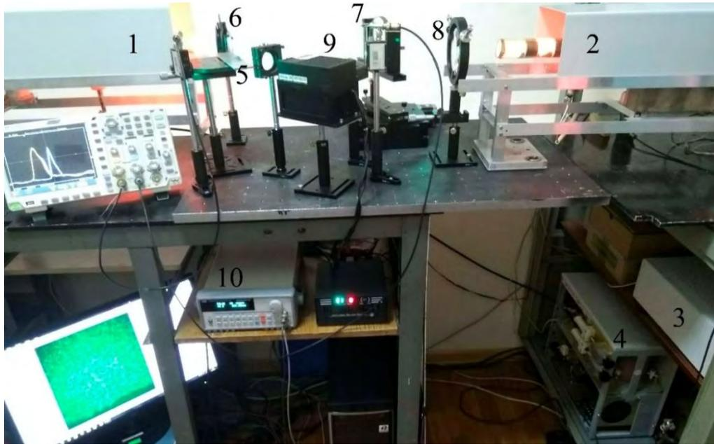
1 – усилитель яркости, 2 – лазер подсветки, 3 – блок импульсного заряда, 4 – тиратронный модуль, 5 – объект, 6 – линза Л1, 7 – зеркало М1, 8 – линза Л3, 9 – инициирующий лазер, 10 – ждущий генератор импульсов
