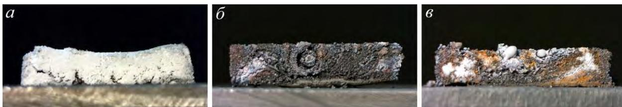
Рисунок 5.57 – Продукты сгорания  $\text{наноAl}$  (а) и смесей  $\text{наноAl} + \text{АСД-6М} + \text{микроFe}$  (б) и  $\text{наноAl} + \text{АСД-6М} + \text{наноFe}$  (в)
