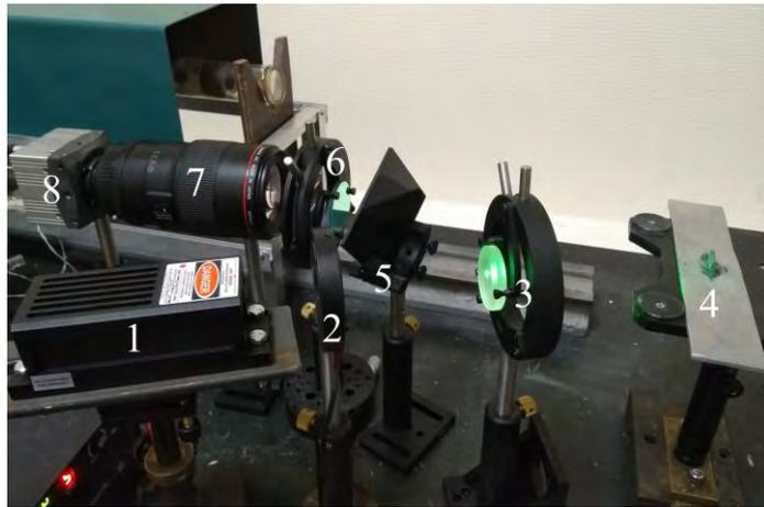
1 – лазер, 2 – механический затвор, 3 – диффузор, 4 – образец, 5 – нейтральный светофильтр, 6 – узкополосный светофильтр, 7 – объектив, 8 – скоростная камера
