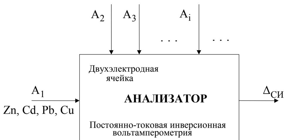
Рис. 3 – Объект метрологического исследования и схема воздействия факторов на анализатор
