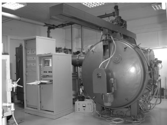
охлаждаемым барабаном. На его боковой поверхности закрепляются полимерные плёнки. Для осаждения покрытий в нижней части цилиндрической камеры горизонтально расположены планарные МРС с мишенями  $700 \times 100$  мм<sup>2</sup>.
