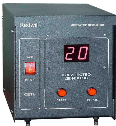
Рисунок 21. Внешний вид имитатора дефектов «ИмД-1»
