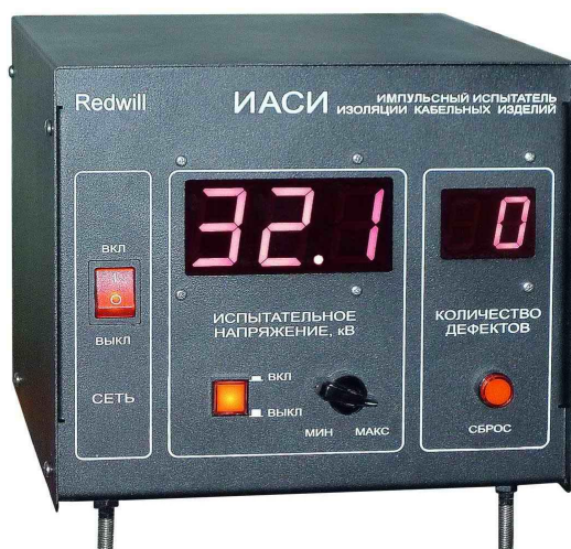
Рис. 20. Внешний вид высоковольтного электроискрового дефектоскопа ИАСИ-30
