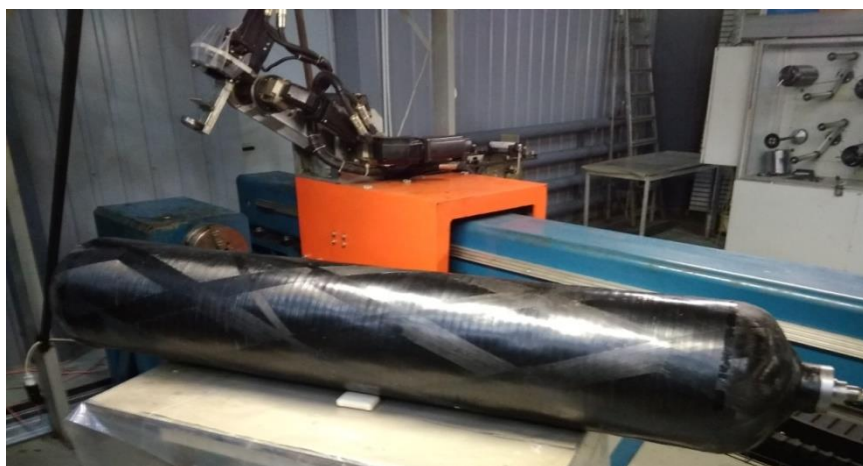
Рис.1.Общий вид полимерно-композитного баллона тип (IV)
