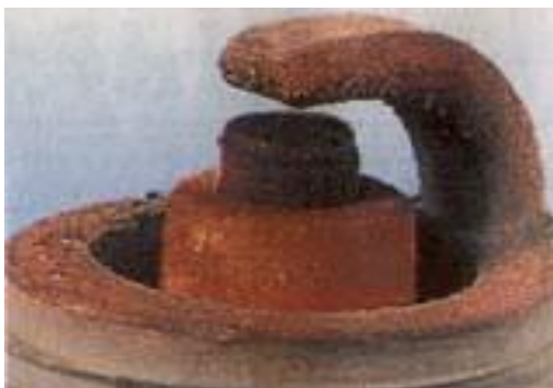
Рисунок 3.2.1 – Отложения железа на свече зажигания
