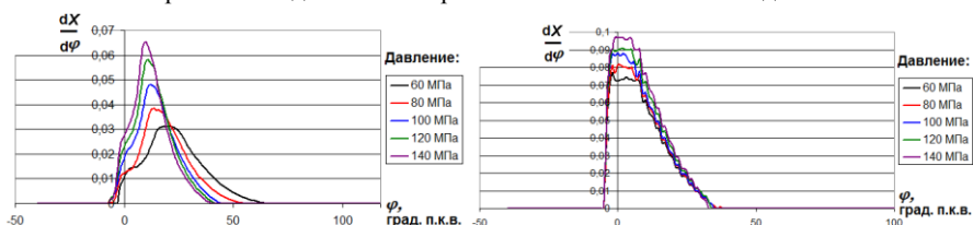
а) с пилотной порцией топлива Рисунок 11 – Поведение скорости тепловыделения при сгорании дизельного топлива при различных давлениях впрыска и способах топливоподачи
