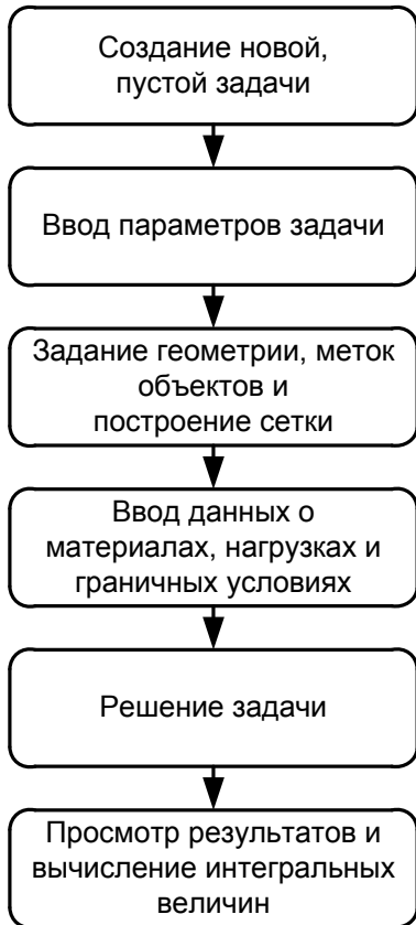
Рис. 2. Блок-схема алгоритма решения задачи магнитостатики в среде ELCUT
