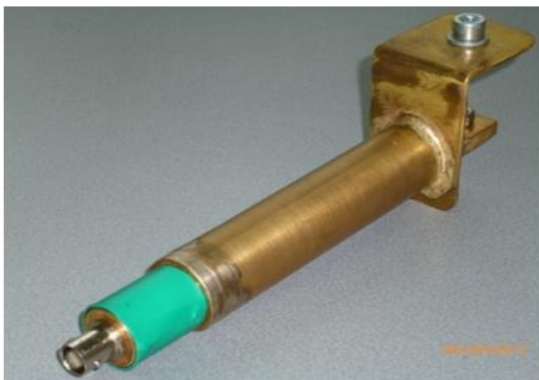
Рисунок 8 – Разработанный прототип коаксиального шунта на 1 кА
