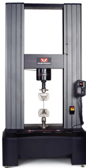
Рисунок 2.8 – Универсальная испытательная машина INSTRON 5982
