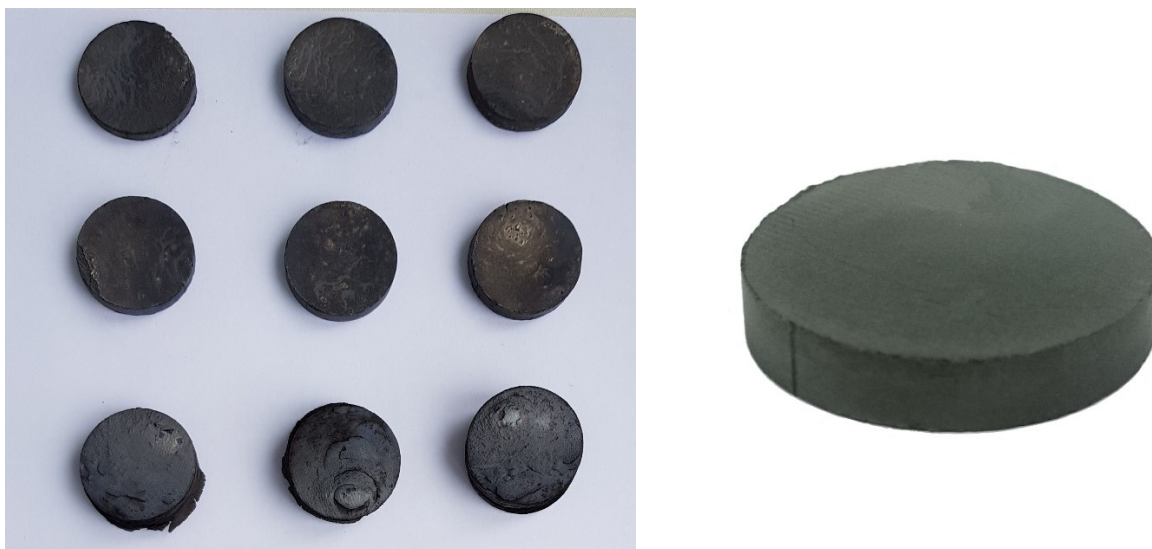
Рисунок 3.16 Фотографии образцов матричного материала, полученного в результате самораспространяющегося высокотемпературного синтеза
