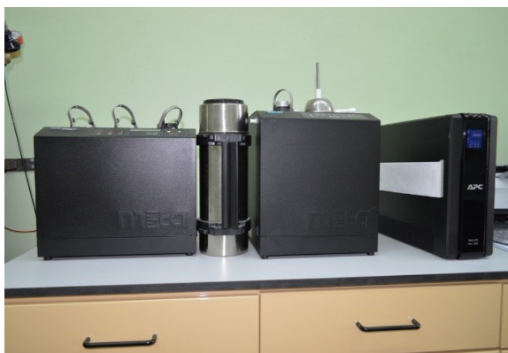
Рисунок 2.5 – Прибор для измерения удельной поверхности пористых материалов серии СОРБИ-М
