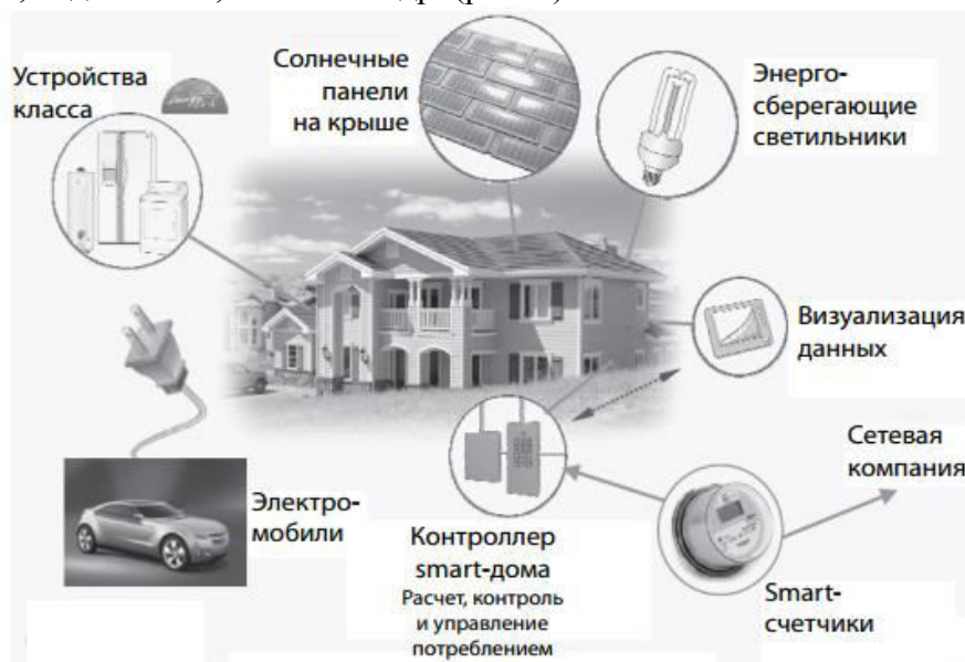
Рисунок 2. Возможности потребителя в энергетической системе на базе Концепции Smart Grid
