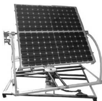
Рисунок 1. Фотография разработанной АФЭУ
