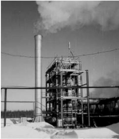
Рисунок 24 – Опытно-промышленная установка зернистого фильтра ФЗГОР-85/16×3
