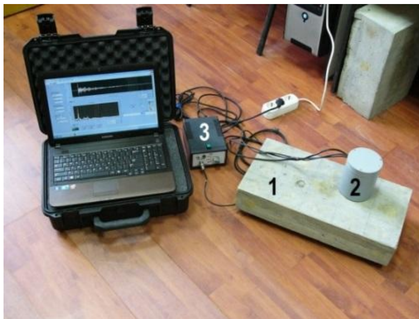
Рисунок 6. Программно-аппаратный комплекс: 1 – лабораторная модель изделия из тяжелого бетона размером 250×500×100 мм; 2 – выносной измерительный зонд; 3 – блок, содержащий портативные источники питания и плату ввода-вывода.
