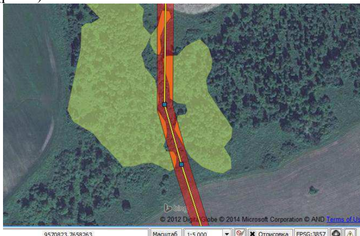
Рис.6. Зоны просек ЛЭП (3540) ВЛ-35кВ, нуждающиеся в расчистке
