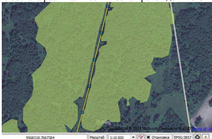
Рис.5. Нанесение слоя растительности («forest») в зоне прохождения ЛЭП (3540) ВЛ-35кВ на карту
