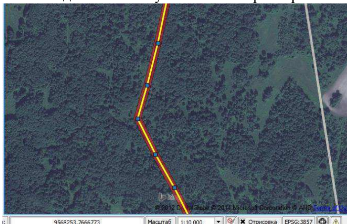
Рис.4. Нанесение охранной зоны ЛЭП (3540) ВЛ-35Кв
