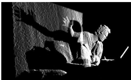
Рис. 3. Построение облака точек с помощью сенсора Kinect
