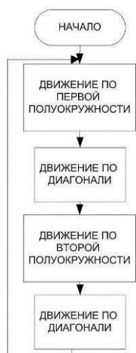
Рис. 2. Блок-схема движения по восьмерке
