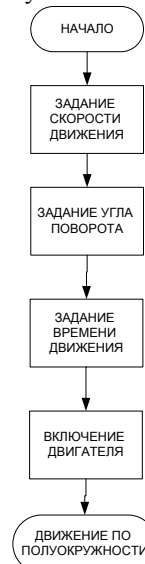
Рис. 4. Блок-схема движения по полуокружности
