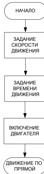
Рис. 3. Блок-схема движения по прямолинейной траектории
