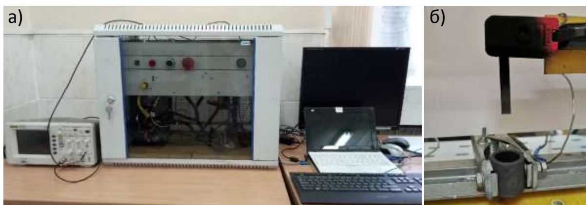
Рисунок 2.2 – Фото собранного плазмохимического реактора постоянного тока совмещенного типа (а) и система электродов «вертикальной» схемы разрядного контура (б)
