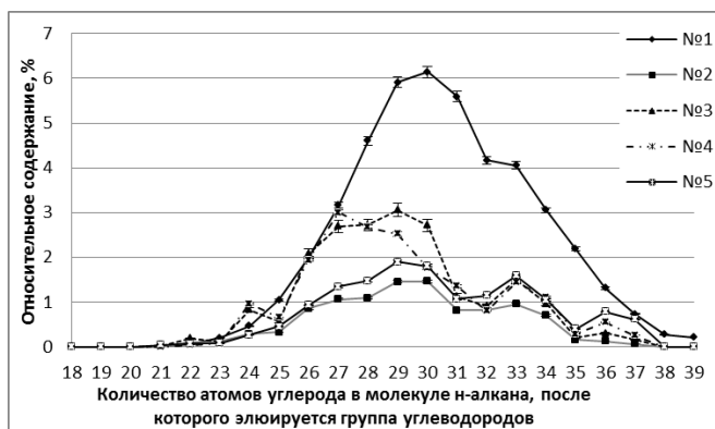
Рис. 11. Зависимость относительного содержания суммы углеводородов, элюирующихся между пиками n-алканов, от числа атомов углерода в их молекулах, входящих в состав гидроизолирующих покрытий тротильных шашек "ТП-200Г-К" пяти производственных партий.
