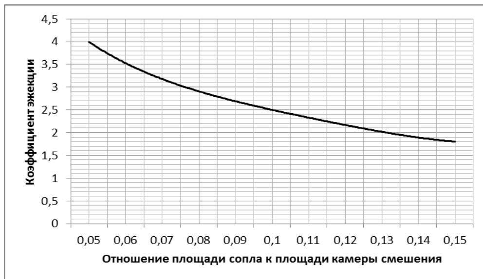
Рис. 9. Зависимость коэффициента эжекции от отношения площади сопла к площади камеры смешения
