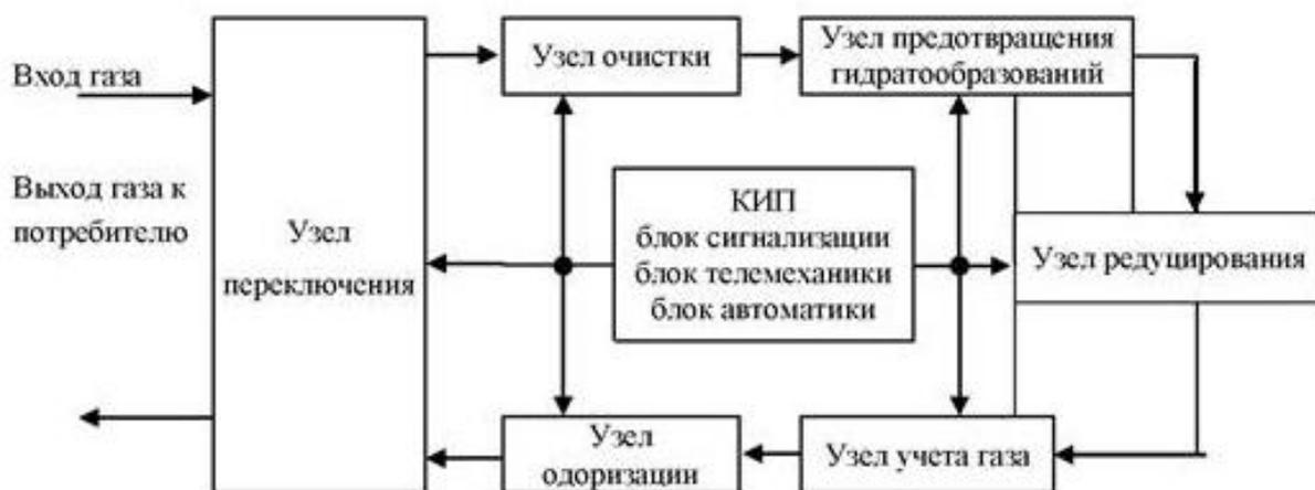
Рисунок 2 – Структурная схема ГРС с одним потребителем [10]
