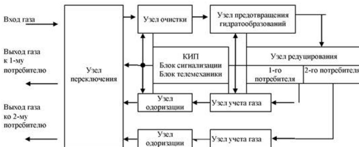
Рисунок 3 – Структурная схема ГРС с двумя потребителями [10]
