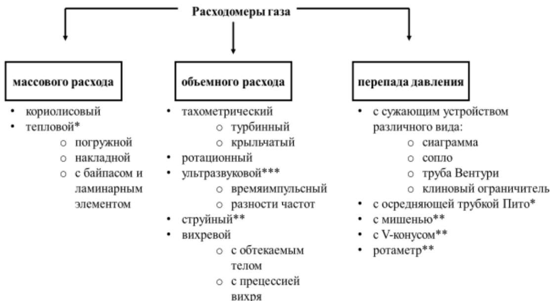
Рисунок 5 – Классификация расходомеров газа по принципу действия
