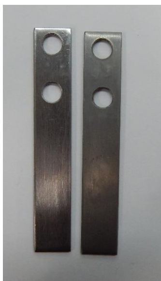
Рисунок 4 – Образцы - свидетели коррозии из углеродистой стали Ст3
