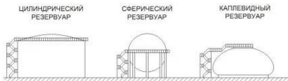
Рисунок 3 Типы резервуаров по формам
