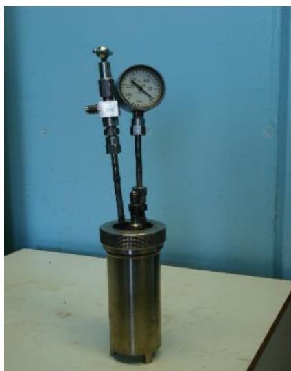
Рисунок 2.4 – Лабораторный автоклав для гидролиза \text{CO}(\text{NH}_2)_2 \cdot \text{HNO}_3
