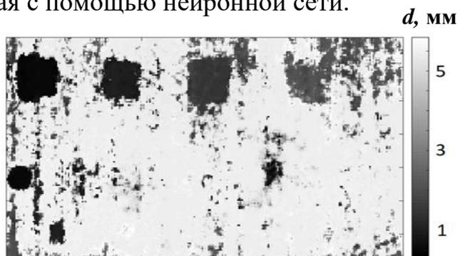
Рисунок 1 – Глубинограмма, полученная с использованием нейронной сети
