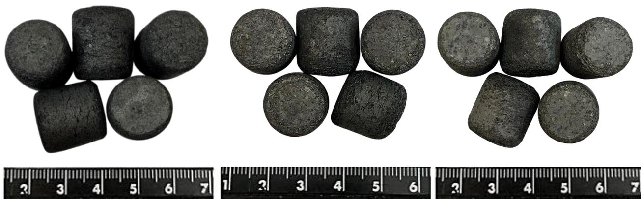
Рисунок 5.12 – Пеллеты после пиролиза при температурах 500, 800 и 950°C (слева направо) и после испытания на истирание
