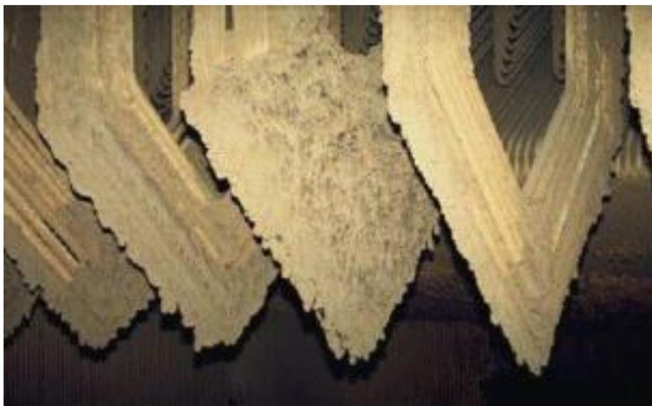
Рисунок 1.4 – Отложения на перегревателе котла при сжигании соломы (ТЭЦ Masnedø, Дания) [81]
