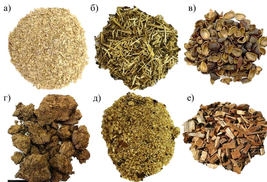
Рисунок 2.1 – Исследуемые образцы биомассы: а) отходы мукомольного производства (ОМП); б) солома; в) скорлупа кедровых орехов; г) суховской торф; д) сосновые опилки; е) щепа
