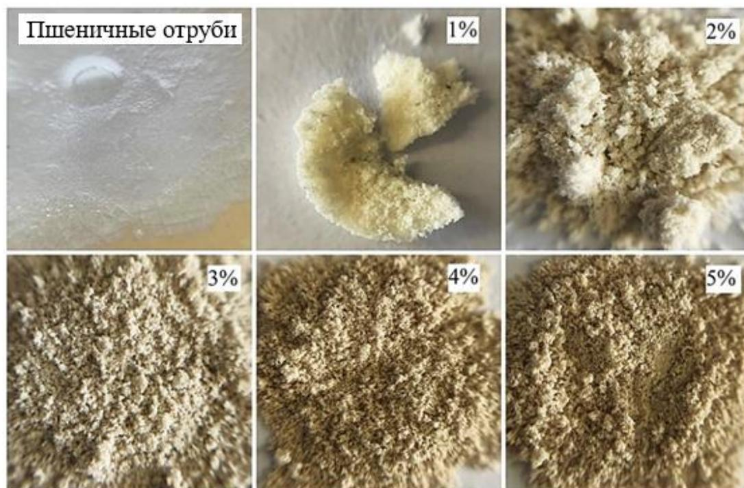
Рисунок 4.9 – Зольный остаток исходных пшеничных отрубей и отрубей с добавлением карбоната кальция (в количестве 1, 2, 3, 4 и 5 мас.%) после сжигания при 815°C [190]
