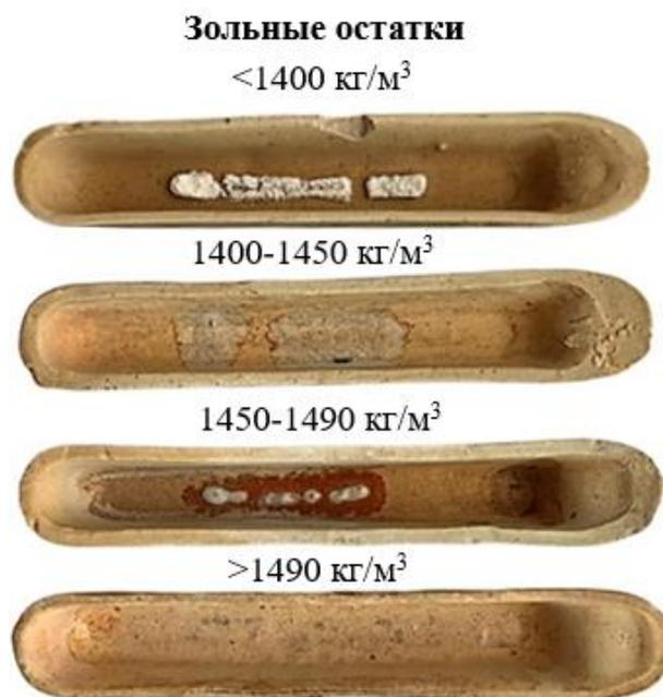
Рисунок 4.6 – Зольные остатки после сжигания различных фракций ОМП при 815°С [190]
