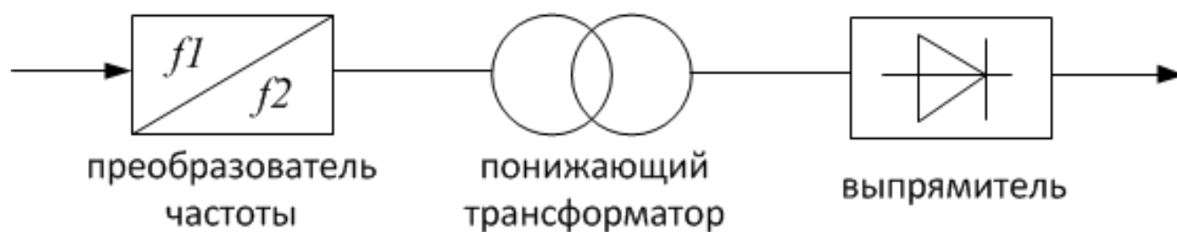
Рисунок 1.2 - Типичная упрощенная схема сварочного выпрямительно-инверторного источника постоянного тока со встроенным преобразователем частоты.
