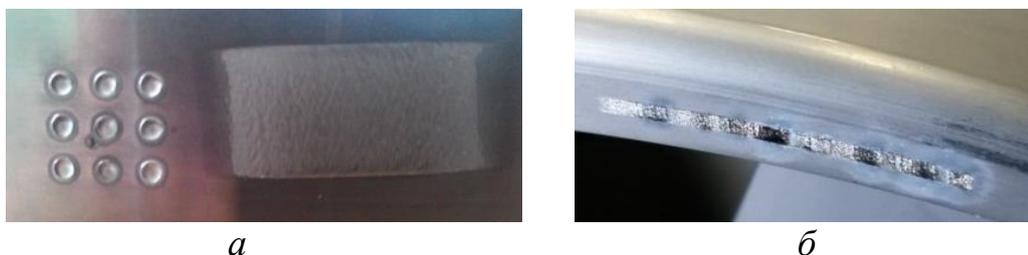
Рисунок 2.9 – Внешний вид ротора (*а*) после балансировки электронным лучом и (*б*) лазером
