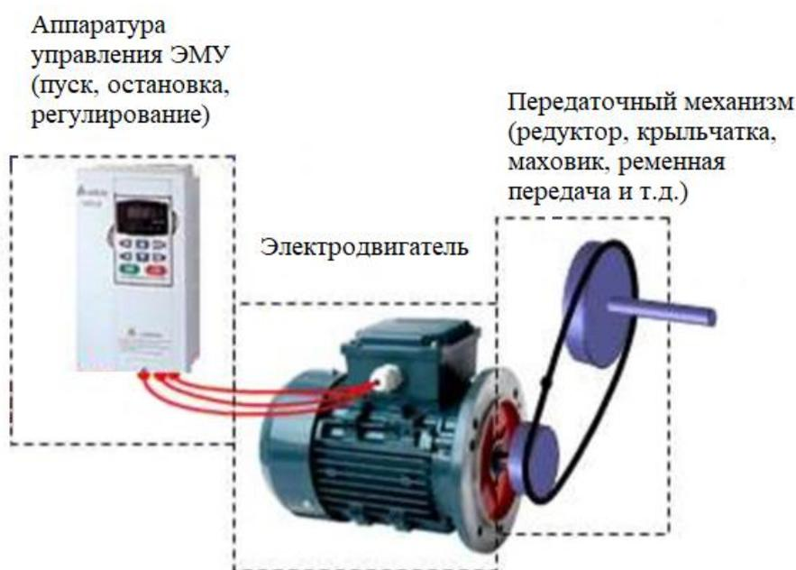
Рисунок 1.1 – Блок-схема ЭМУ
