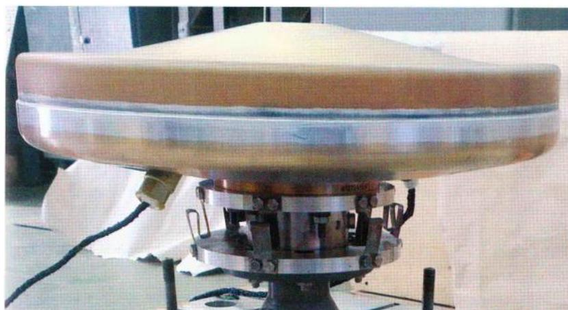
Рисунок 1.27 – Опытный образец виброизолятора с ЭМУ
