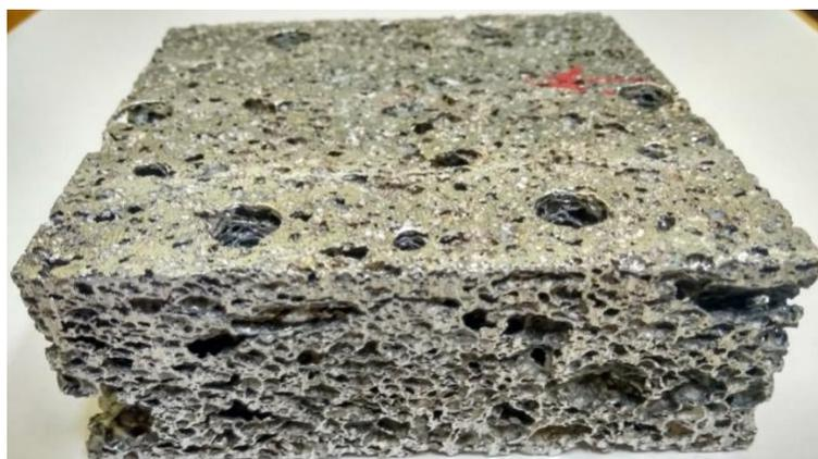
Рисунок 3.5 – Фрагмент демпфирующего элемента гасителя колебаний твердотельного демпфера на основе пеноалюминия
