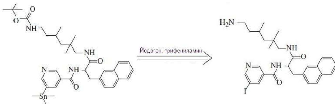
Рисунок 1.8 – Схема введения йода-123 в молекулу аналога IC-2
