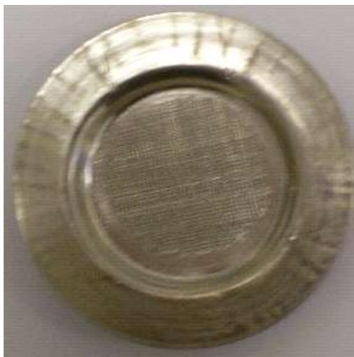
Рисунок 3.1 – Внешний вид платиновой подложки для нанесения оксида  $^{122}\text{TeO}_2$
