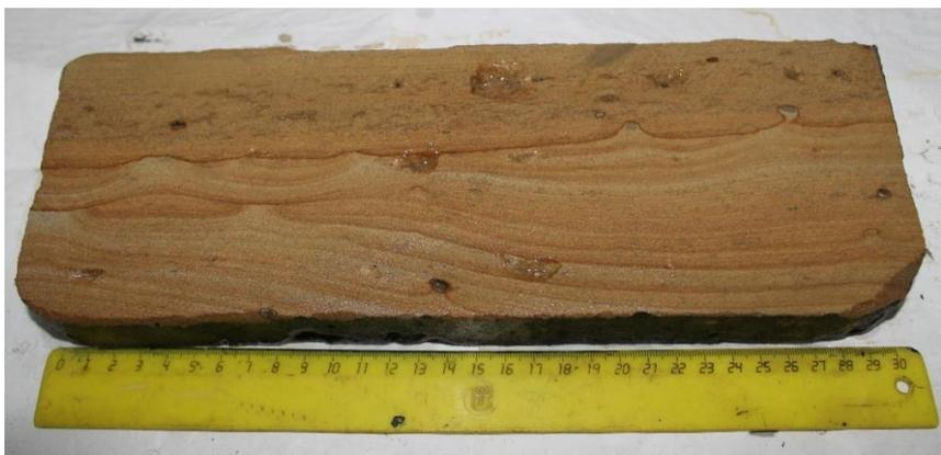
Рисунок 5 – Внешний вид образца песчаника 150x100x50
