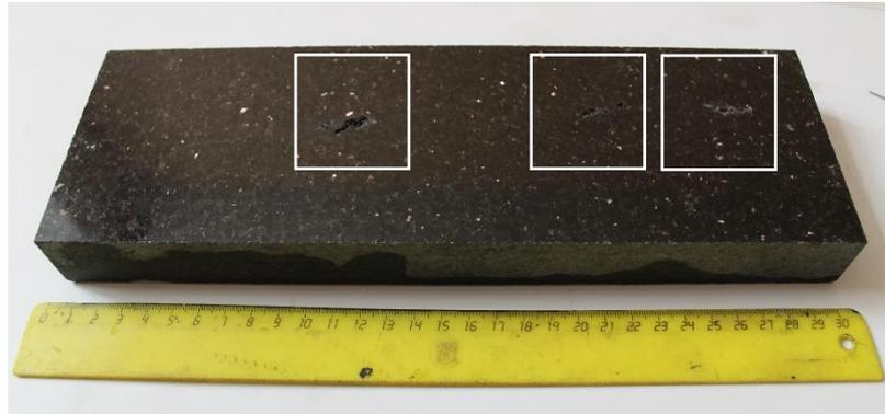
Рисунок 18 – Образец гранита со следами внедрения и откола после одного импульса напряжения в среде минерального масла
