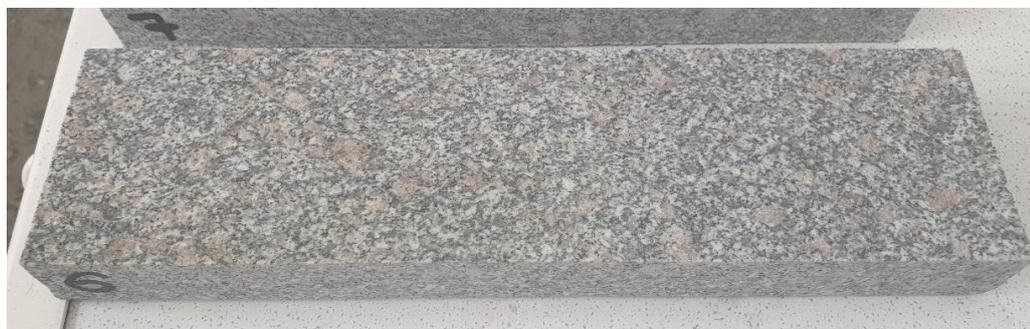
Рисунок 6 – Внешний вид образцов гранита 300x80x30
