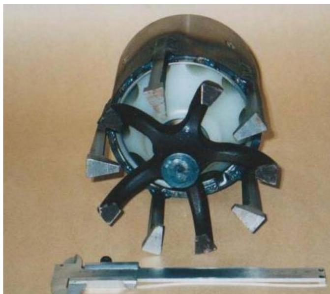
Рисунок 3 – Внешний вид бурового наконечника диаметром 150 мм
