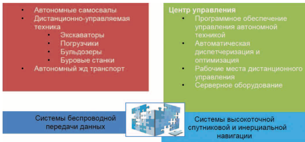
Рис. 1. Структура роботизированной системы на горном предприятии
