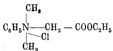
нагреванием диметиламилина и хлоруксусного эфира в запаянной трубке до 100° в течение 4 часов.
