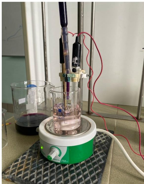
**Рис. 2.** Схема потенциометрической установки
