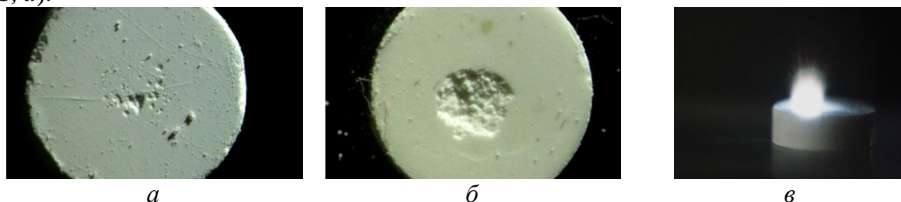
Рисунок 3.3 – Морфология разрушений тэна при облучении однократным импульсом Nd – лазера с плотностью энергии H = 4 ( а ) и 6 Дж/см 2 ( б ) и свечения ( в ) при H = 6 Дж/см 2
